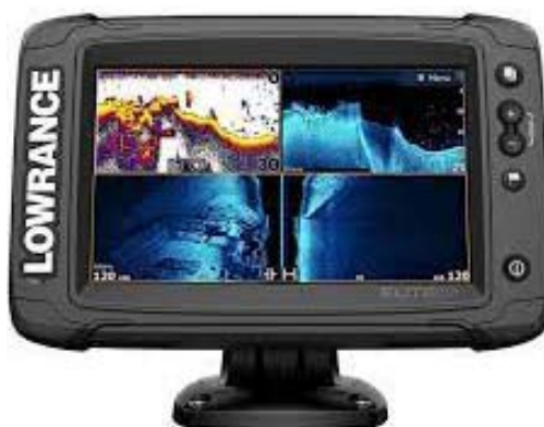
Figura 2. Modelo de ecosonda utilizado en este estudio. Foto: Sorelló.
