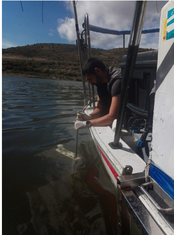
Figura 8. Técnico realizando el perfil vertical mediante sonda multiparamétrica
