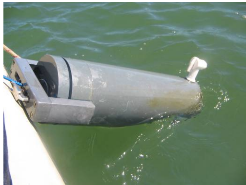
Obtención de muestras de agua, mediante botella hidrocaptora.
