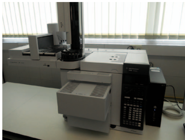
Cromatógrafo de gases con detector FID para análisis de fracciones de hidrocarburos.
