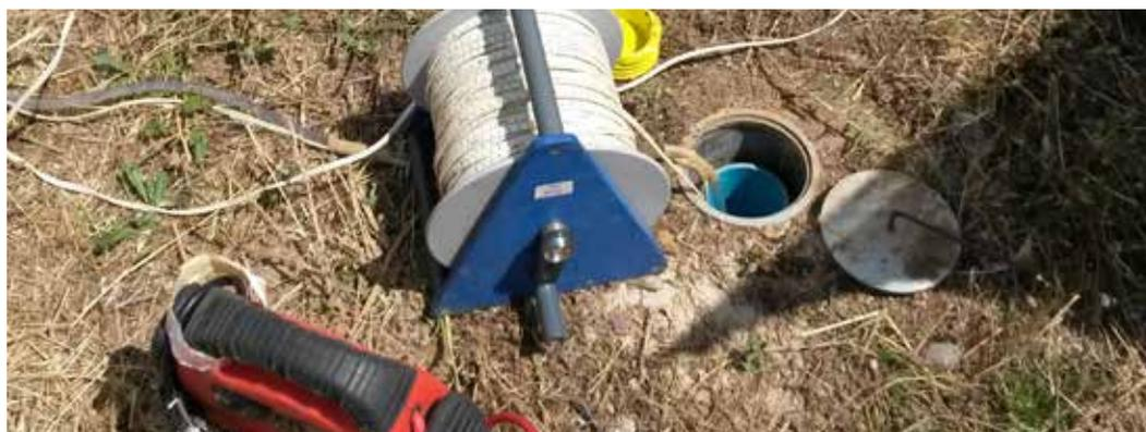
*Control piezométrico de agua subterránea*
