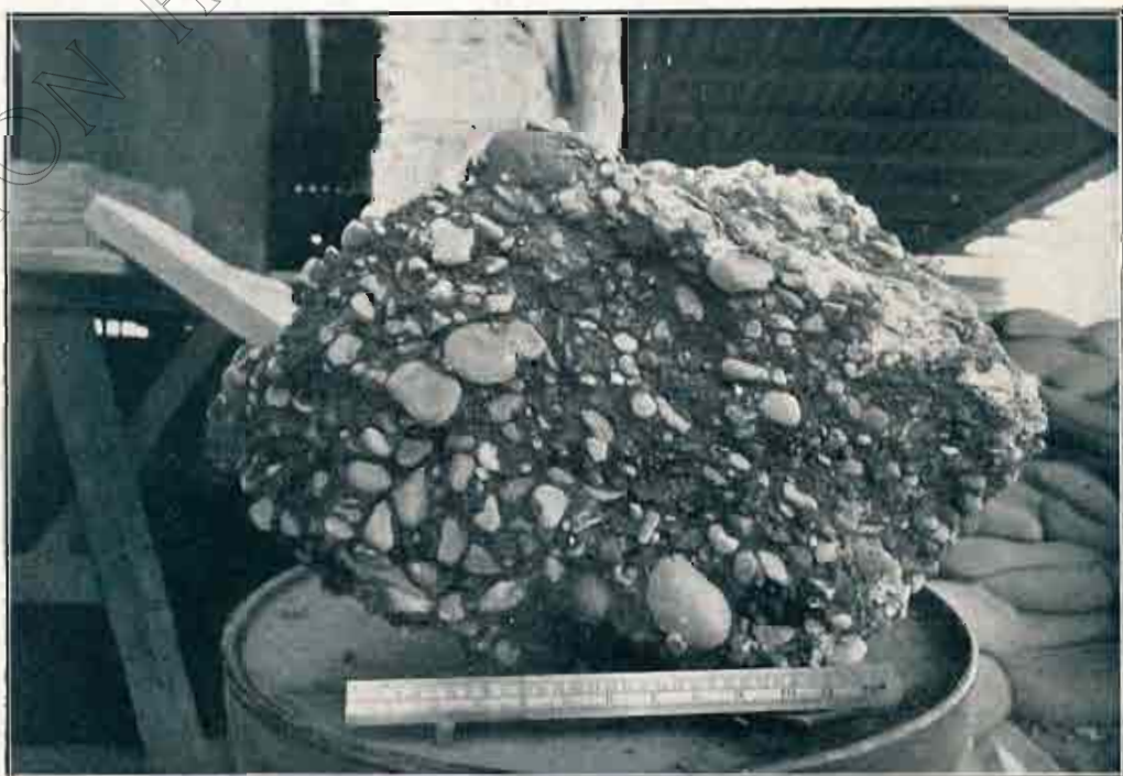
MEJORA DE BLOQUE DE GRAVA CONSOLIDADA CON LA INYECCIÓN DE CEMENTO, EXTRAÍDA EN UNA ESCAVACIÓN DE LA OBRA
