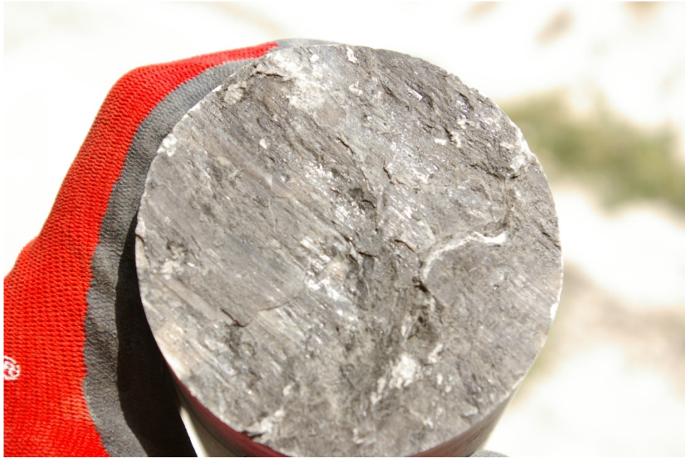
Figura 16. Plano estriado con fibras de calcita en el sondeo SCI-2 a la profundidad de 91,1m. El buzamiento del plano es de 16^\circ y un pitch 5^\circ . Se interpreta como plano/zona de debilidad del macizo rocoso pero que no muestra indicios de movimiento reciente.
