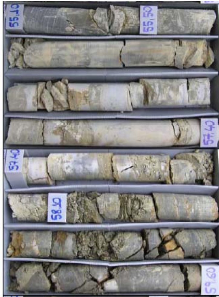
Figura A1.5. Unidad Inferior del Flysch –F1 (Sondeo SC-6, profundidad 55,1 a 59,6m). Las argilitas tienen un color gris oscuro cuando no están meteorizadas, mientras que las areniscas muestran generalmente un color gris claro.
