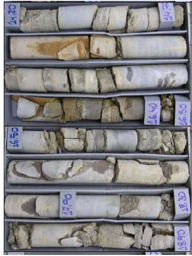
Figura A1.7. Unidad Superior del Flysch –F3 (Sondeo SC-6, profundidad 14,2 a 18,9m)
