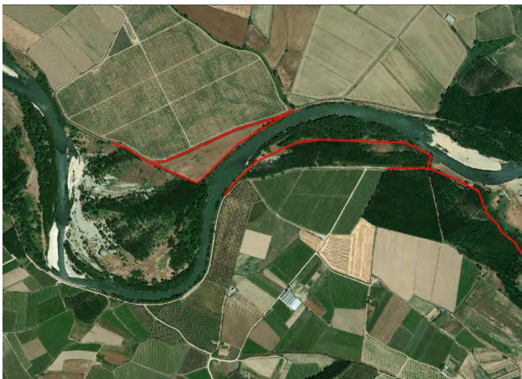
Imagen 7: Tramos de mota a demoler en la zona 1
