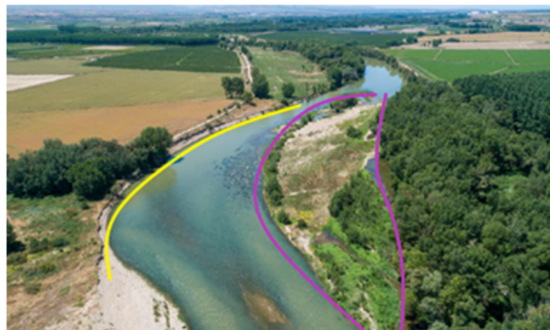
Imagen 3. En amarillo la erosión en la margen derecha ("D" en la imagen 2) y en magenta la delimitación la isla formada en la margen opuesta.
