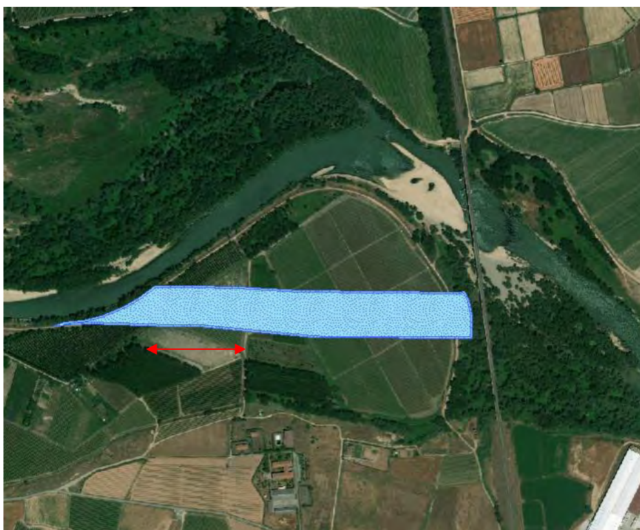
Imagen 19: Cauce de alivio. La flecha roja indica la zona de rellenos antrópicos.
